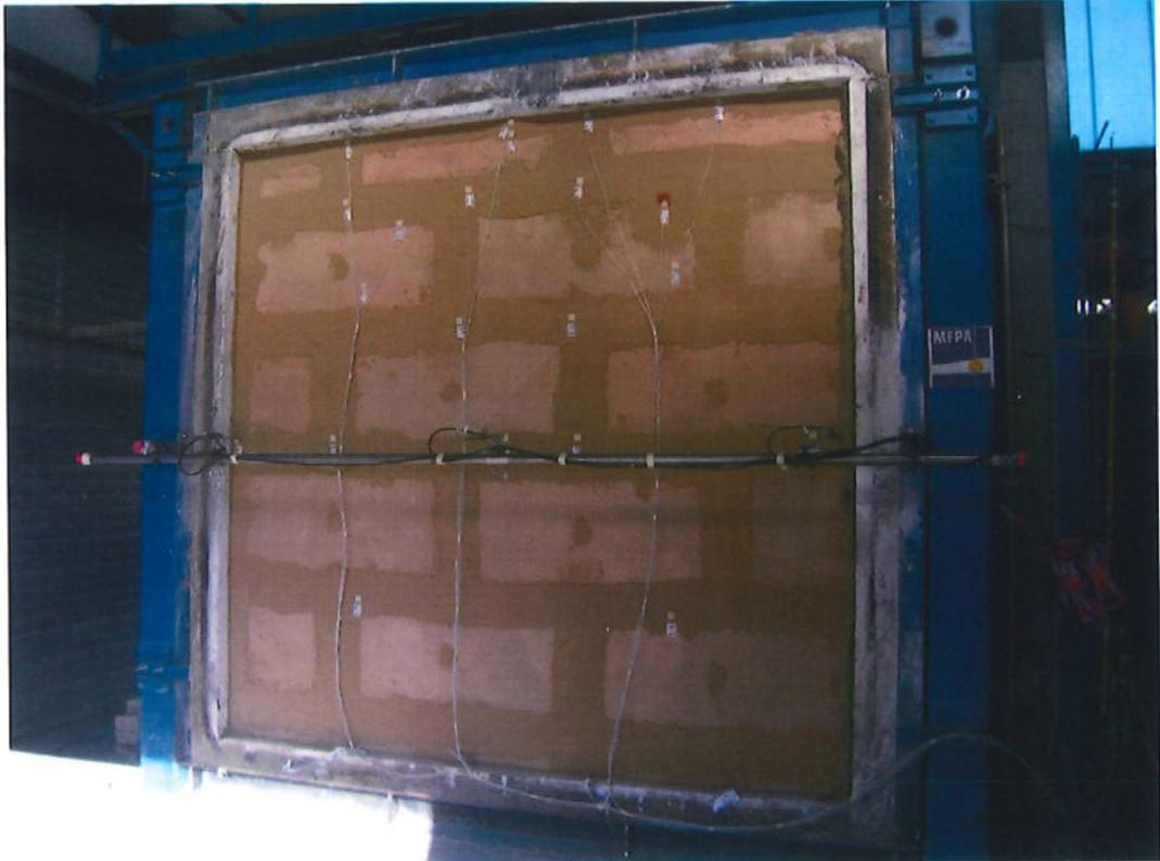
Bild A5.13: Ansicht der Wandkonstruktion vor Beginn der Feuerwiderstandsprüfung.
