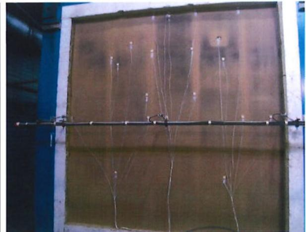
Bild A6.12: Prüfminute 57, deutliche Verfärbungen auf der Oberfläche der feuerabgewandten Seite.
