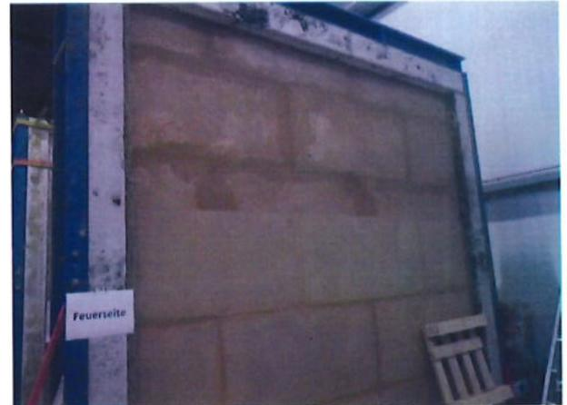
Bild A5.4: Verspachtelung der inneren Plattenlage mit AGATON „Feinputz“ sowie Montage der äußeren Plattenlage Lehmplatte „Lemix 2.0“ mit  $d = 16 \text{ mm}$ .
