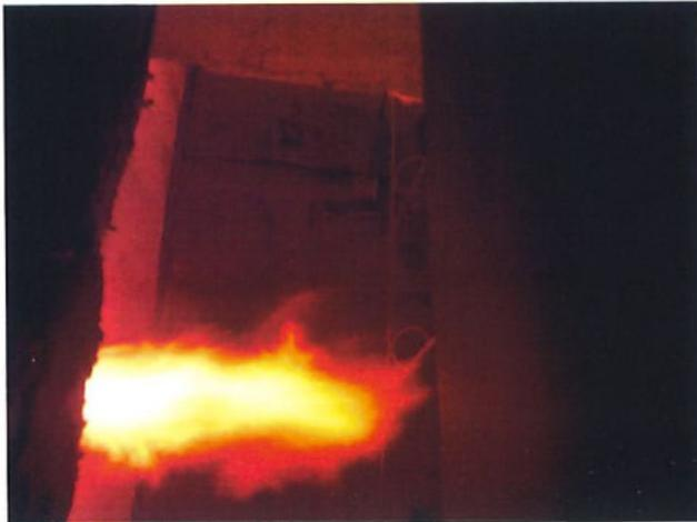
Bild A6.1: Prüfminute 4, Schwarzfärbung der äußeren Plattenlage Lehm- bauplatte „Lemix 2.0“.
