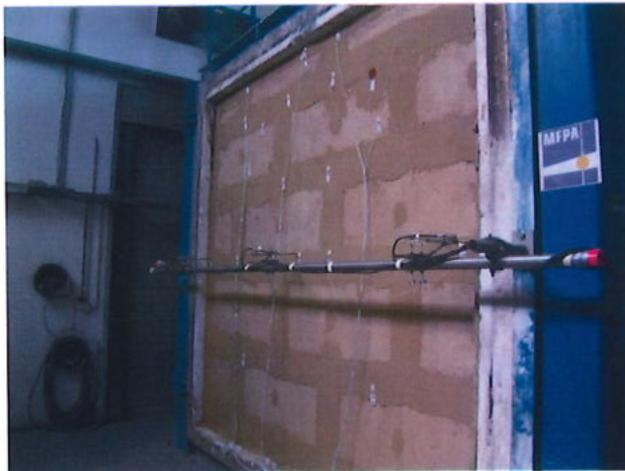
Bild A6.9: Prüfminute 116, wahrnehmbare Verformung der Wandkonstruktion Richtung Brandraum.
