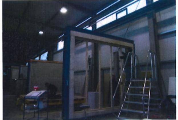
Bild A5.2: Ansicht der Holztragkonstruktion. Dreiseitige Befestigung des Rahmens mit Fischer Nageldübel  $\varnothing$  8,0 x 120/80S im Abstand  $a = 625$  mm.
