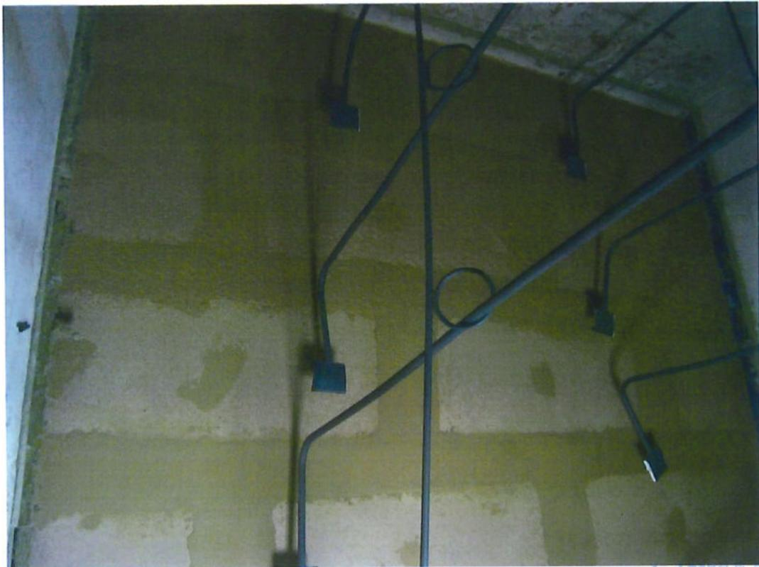
Bild A5.14: Ansicht der Wandkonstruktion vor Beginn der Feuerwiderstandsprüfung (Feuerseite).
