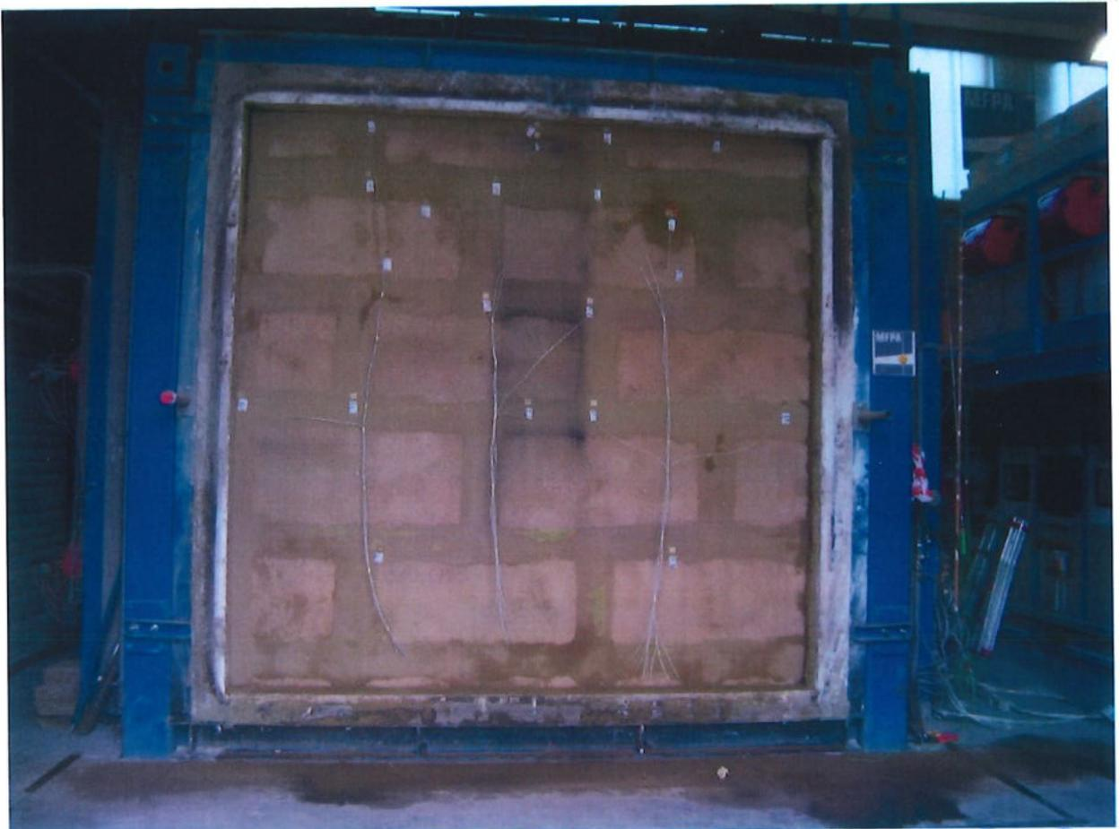
Bild A6.11: Ansicht des Probekörpers auf der feuerabgewandten Seite nach Beendigung der Prüfung.
