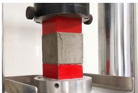
La classe la plus utilisée est le C25/30, cela veut dire une résistance caractéristique à la compression sur cube de 30 N/mm<sup>2</sup> ou une résistance caractéristique sur cylindre de 25 N/mm<sup>2</sup>. Cette classe est conseillée pour le bétonnage des poutres, des colonnes, des planchers et autres éléments armés. La fabrication du béton n'est pas une simple recette constituée de ciment, d'agrégats et d'eau.
