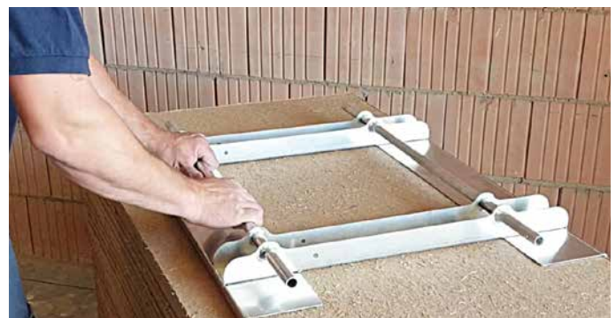
Transporthilfe für Lehmbauplatten
